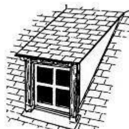
lucarne rampante ou en chien couché
